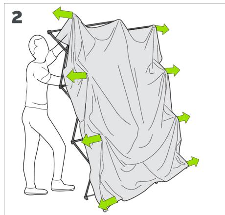
Déployez la structure en la penchant légèrement vers l'arrière.
