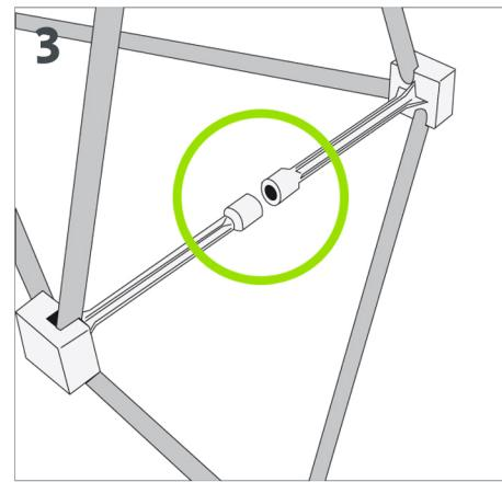
Les connecteurs magnétiques puissants permettent à la structure une fermeture automatique en quelques secondes.
