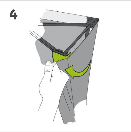
Accrochez le visuel sur l'arrière pour bien le tendre. Attention à bien le décrocher à l'arrière avant de replier la structure.
