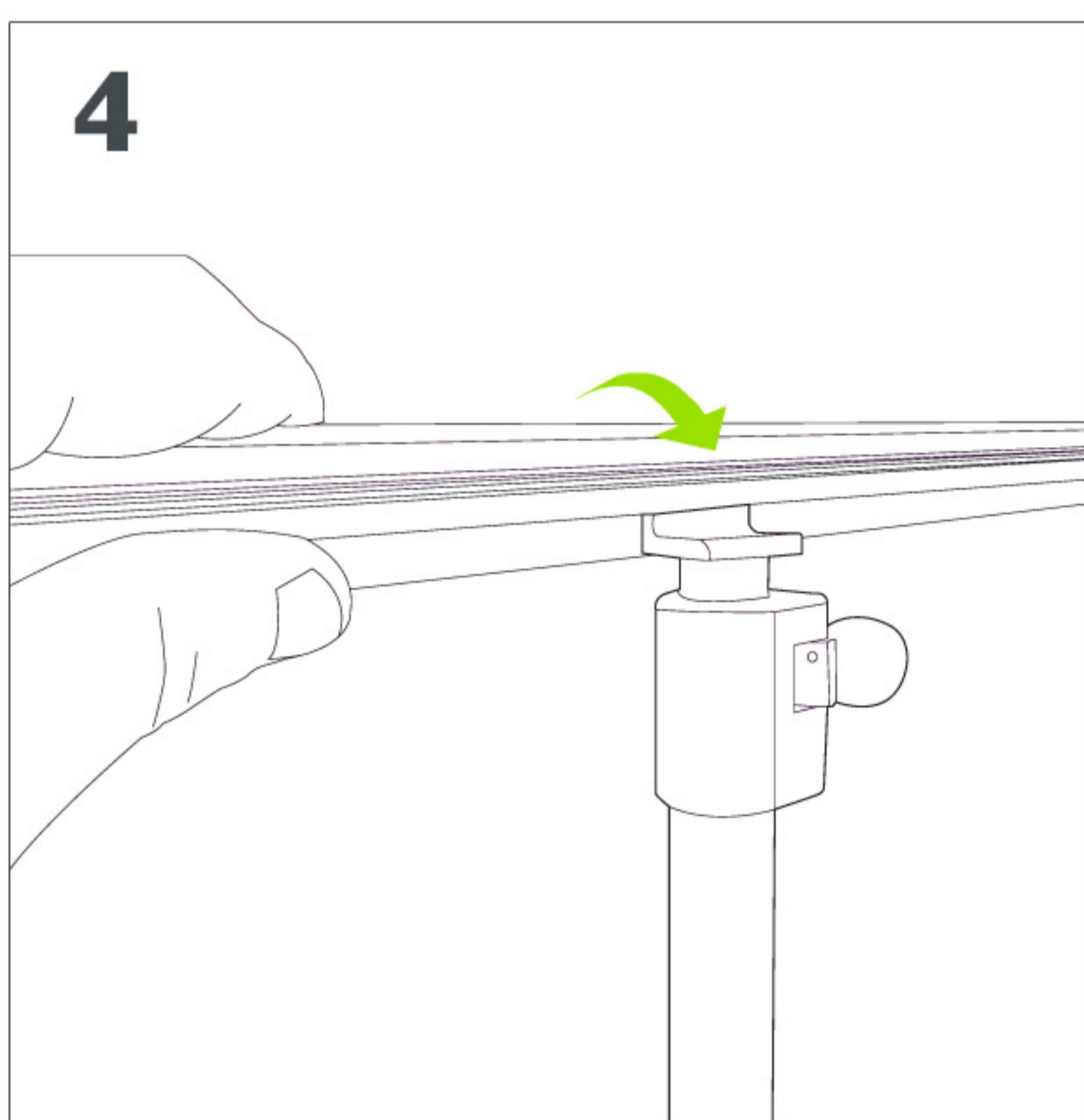
Insérez la suspente du visuel au centre de la tête de mât.
