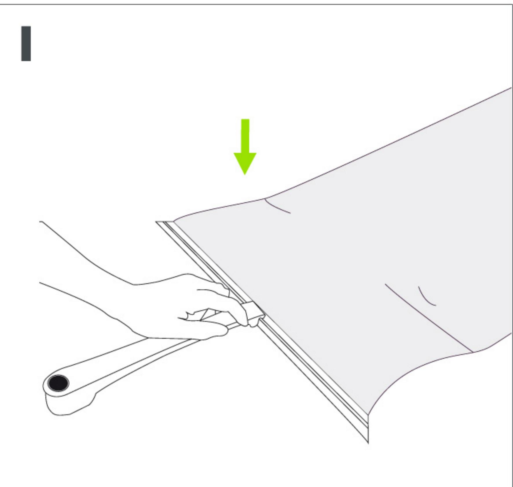
Sur une surface propre, placez le pied dans la rainure de la plinthe du visuel en le centrant.
